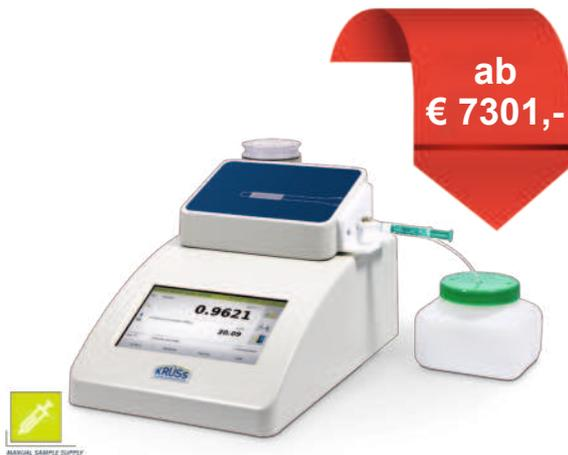
Diese digitalen Dichtemessgeräte für die manuelle Probenzufuhr arbeiten mit der bewährten Biegeschwingertechnologie. Die interne Peltiertemperatur sorgt für eine schnelle und stabile Probentemperatur. Mit Hilfe der am Gerät befestigten Trocknungseinheit werden alle Flüssigkeitsreste aus den Biegeschwinger beseitigt. Das benötigte Mindestprobenvolumen des Biegeschwingers liegt unter 1 ml.
